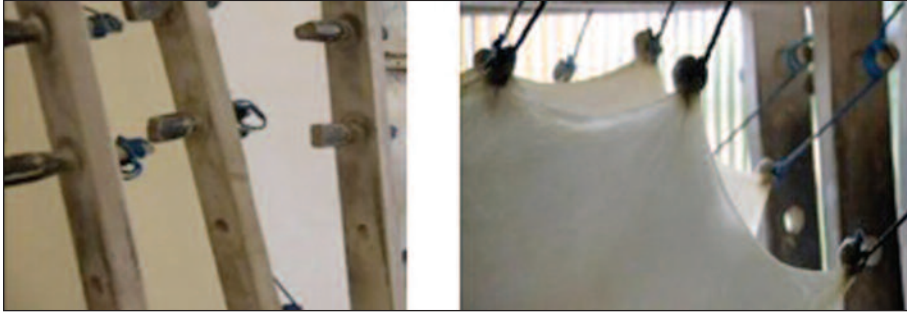
Şekil 5. Parşömenlerin gerilmesi amacıyla tutturuldukları mandallar ve yerleştirdikleri ahşap gergiler.
