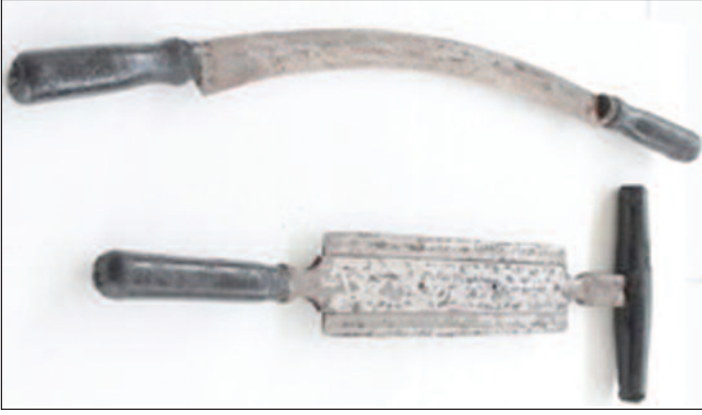
Şekil 4. Kıl giderme kireçlik işleminden sonra et tarafında kalan fazlalıkları uzaklaştırmak için kullanılan bıçak.
